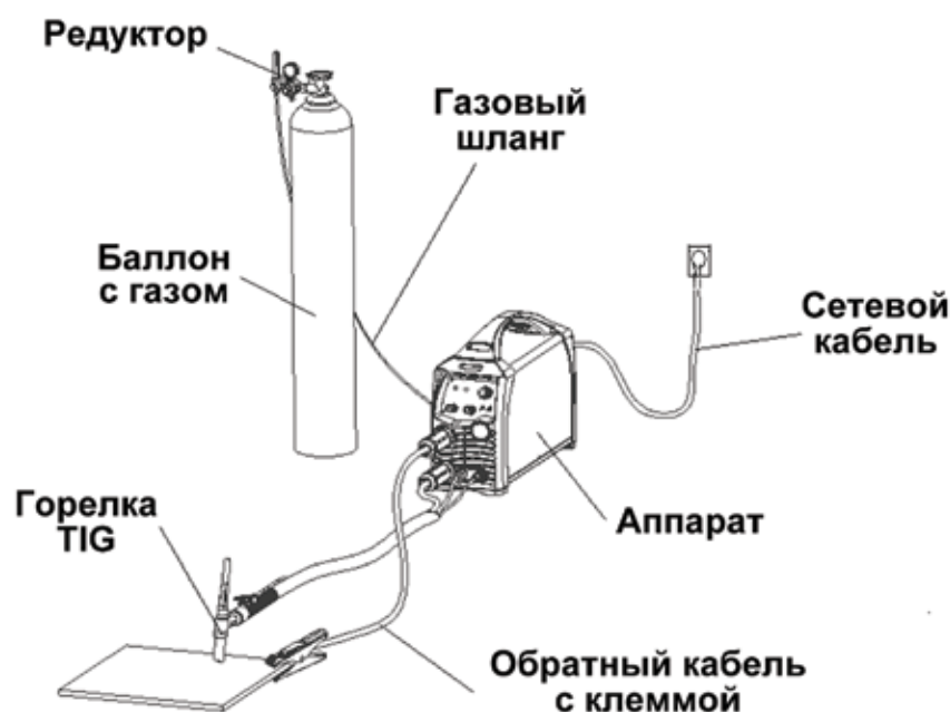
Рис. 6.2 Схема подключения оборудования для TIG сварки
